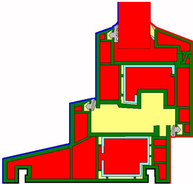
Figur 36. Vindue med isolering i hulrum.
